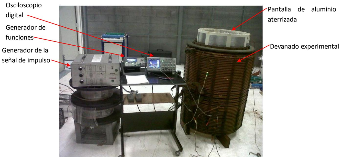
Figura B.1. Devanado y equipo de medición experimental.
