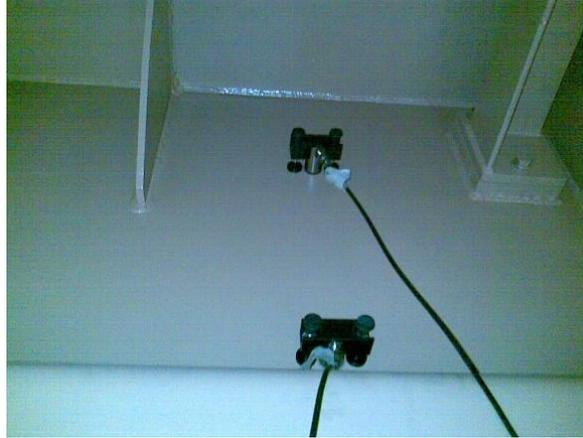
Figura 2.7. Dos transductores colocados en la pared del tanque del transformador
